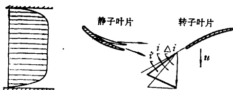
图2 静子叶片端弯前后(细线为原型, 粗线为端弯叶片), 下级转子叶片攻角(尖、根)变化
